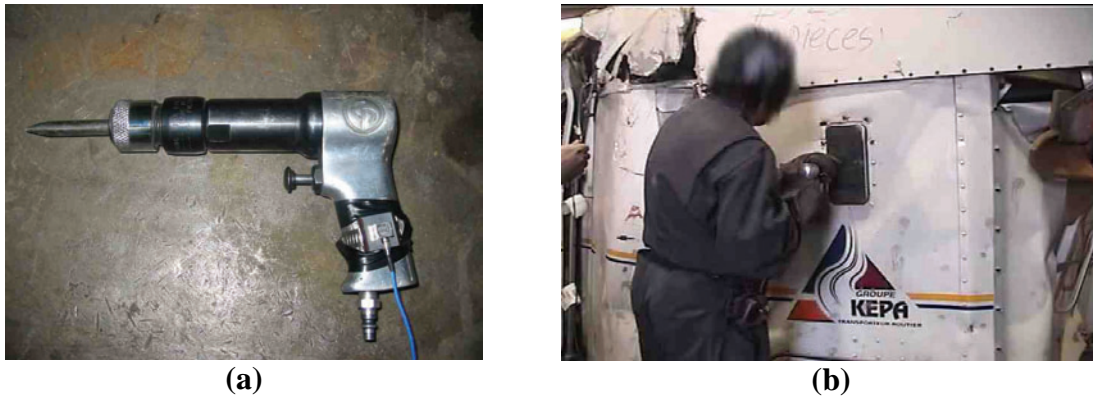
Figure 35. Utilisation du marteau pneumatique dans les garages
