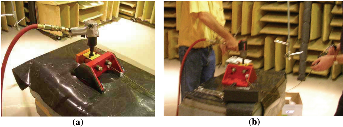
Figure 15. Banc d'essai de première génération pour la clé pneumatique à impact
