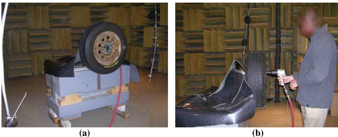
Figure 16. Banc d'essai de deuxième génération pour la clé pneumatique à impact
