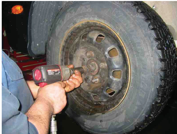
Figure 14. Utilisation de la clé pneumatique à impact dans les garages
