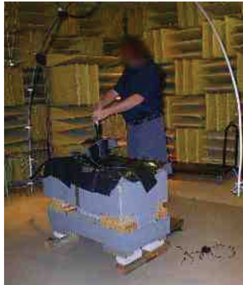
Figure 36. Banc d'essai de première génération pour le marteau pneumatique
