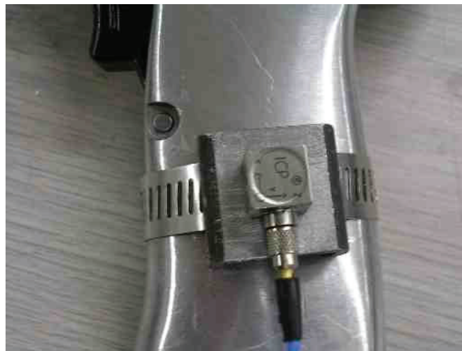
Figure 4. Fixation d'un accéléromètre triaxial avec collier de serrage
