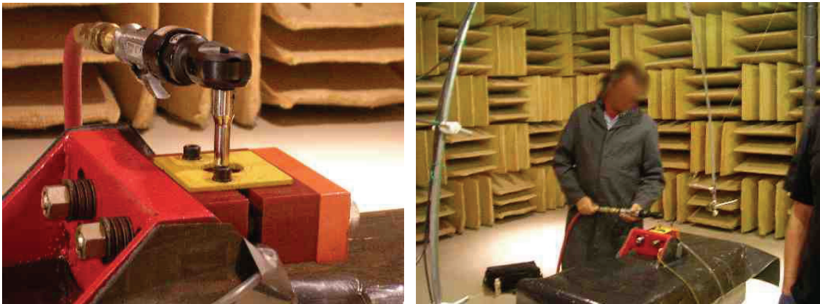
Figure 8. Banc d'essai de première génération pour la clé pneumatique
