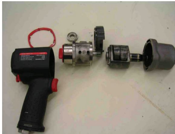
Figure 22. Vue éclatée de la clé à impact A1
