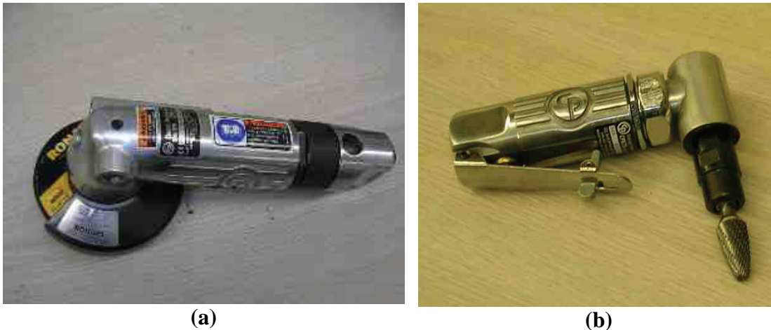
Figure 24. Meuleuse avec disque à couper (a), meuleuse d'outillage avec pointe au carbure (b)
