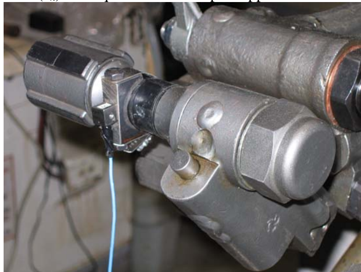
Figure 5. Positionnement de l'accéléromètre triaxial sur la poignée d'une foreuse
