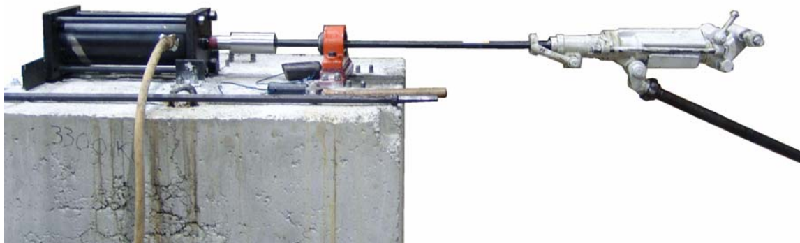
Figure 4. Photo du banc d'essai avec foreuse à béquille
