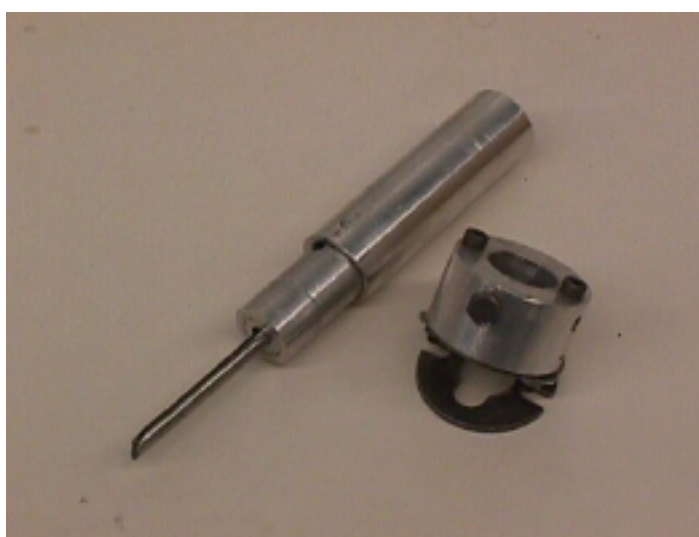
Figure 13 Premier prototype de l'outil à percer avec son support-guide.
