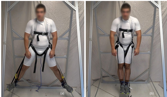
Figure 17. Suspension du participant dans le harnais B (modèle en H) avec trauma straps : (a) deux étriers séparés, (b) sangle unique.
