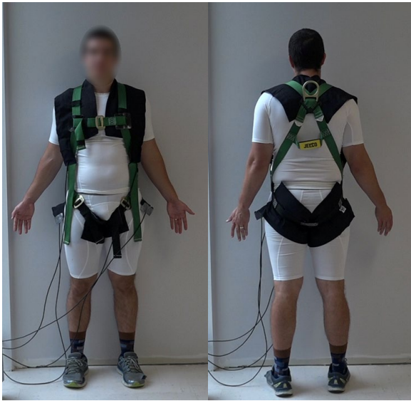
Figure 15. Harnais D avec les tapis de pression installés sur le participant.
