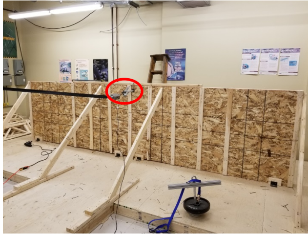
Figure 14. Essai de traction sur le mur préfabriqué.
