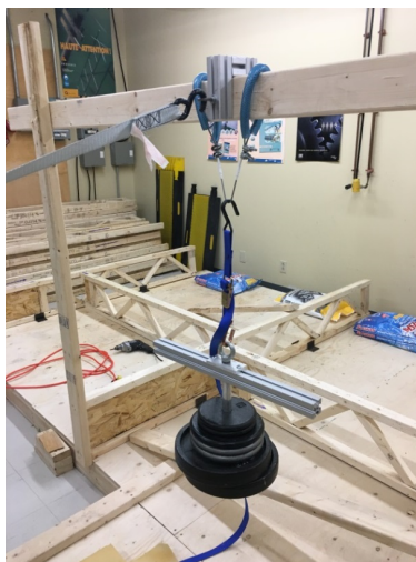
Figure 10. Dispositif permettant l'application de la charge verticale.
