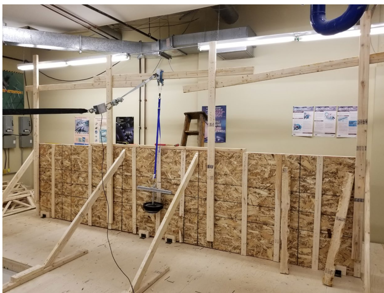
Figure 29. Garde-corps installé sur le mur préfabriqué, fixation CL31 et configuration 3T-C, avec espacement des clous de 24 po.
