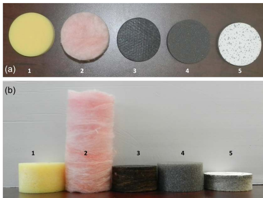
Figure 5 – Échantillons destinés aux mesures en tube d'impédance : (a) Vue supérieure des échantillons; (b) Vue latérale des échantillons – (1) mousse de mélamine, (2) laine de verre, (3) panneau de fibre de verre compressée, (4) mousse PU, (5) tuile de plafond.
