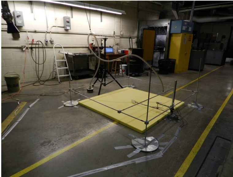
Figure 66 – Mesures pour le cas de la mousse de mélamine dans le local « atelier ».
