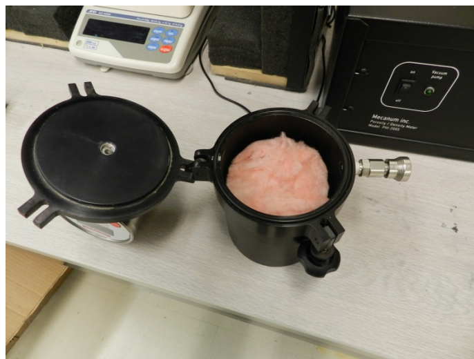
Figure 53 – Mise en place d'un échantillon de laine de verre dans le porte-échantillon pour la mesure de la résistivité au passage de l'air statique.
