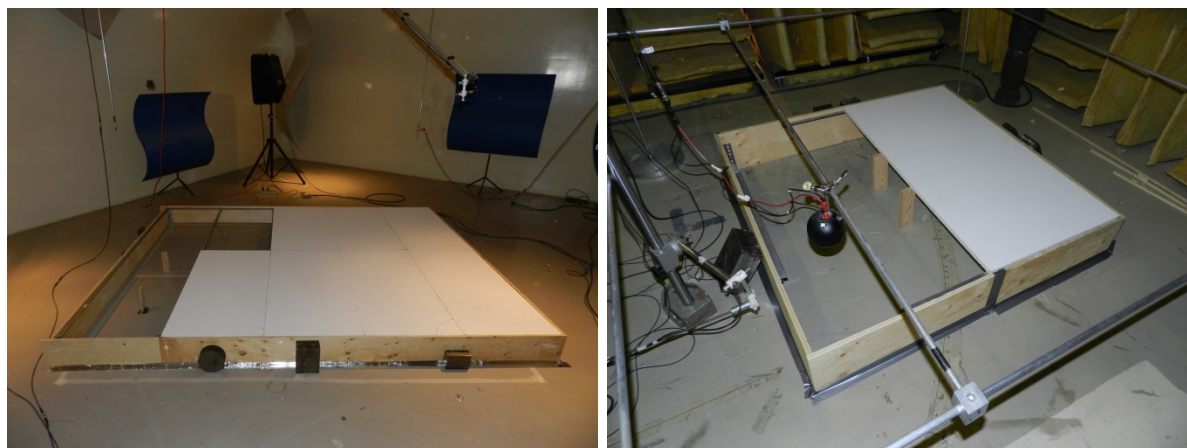
Figure 17 – Montage de la tuile de plafond pour la mesure d’un montage de type E-200 en chambre réverbérante (à droite), et pour la méthode proposée (à droite).
