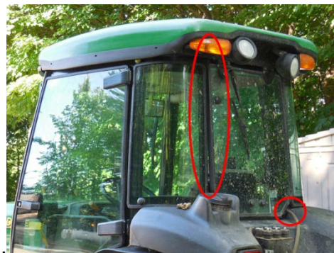
Figure 5 : Cabine de tracteur avec présence d'ouvertures
