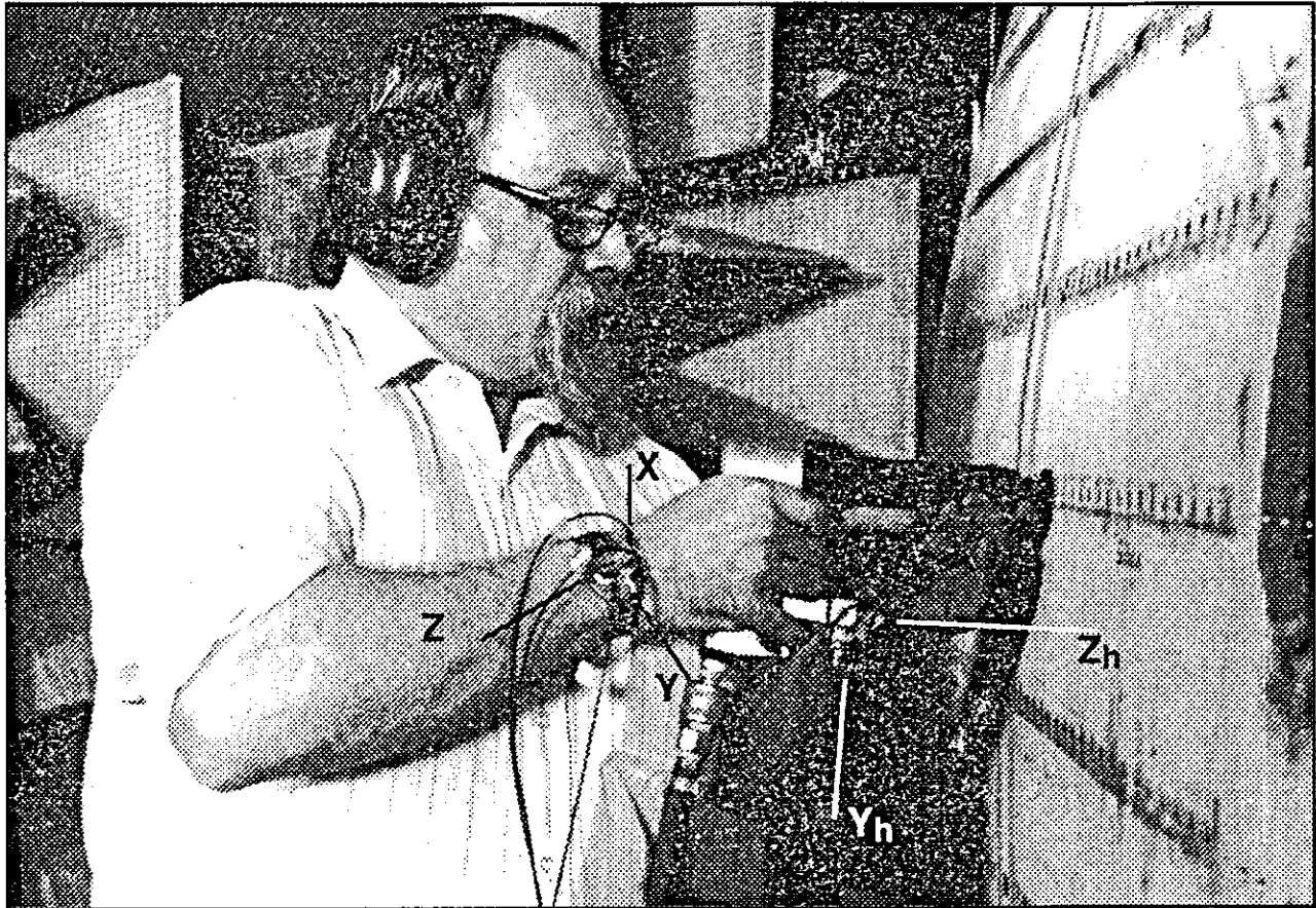
Figure 4 : Montage et orientation des accéléromètres sur la poignée et au poignet du côté du marteau-riveteur
