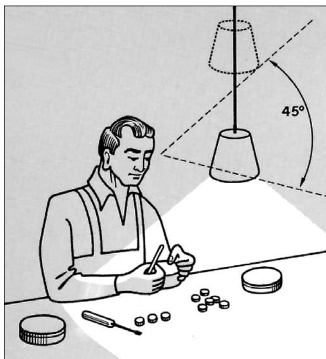
Figure 78a. Une lampe équipée d'un abat-jour doit être placée à bonne hauteur
