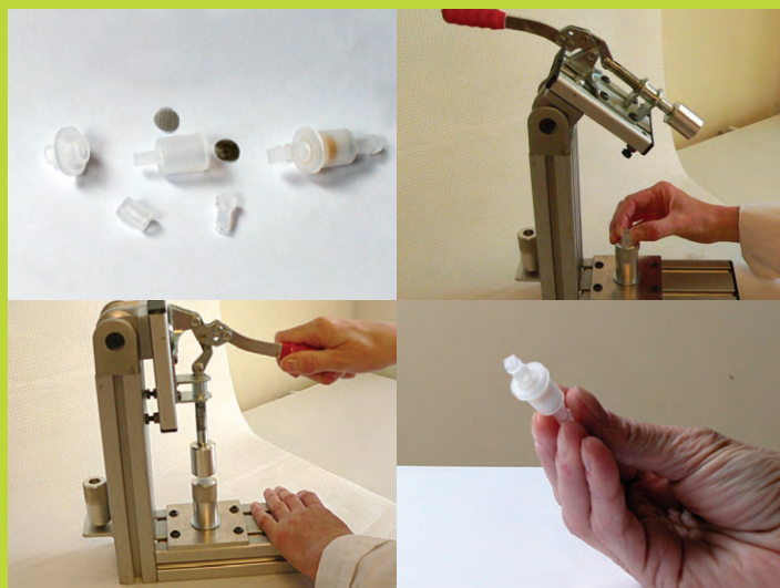
L'assemblage des cassettes utilisées pour l'analyse des nitrosamines nécessitait la répétition de manipulations fines et l'exercice d'une certaine force. Des gestes qui ne sont plus requis grâce à cet appareil développé dans les laboratoires de l'IRSST.
